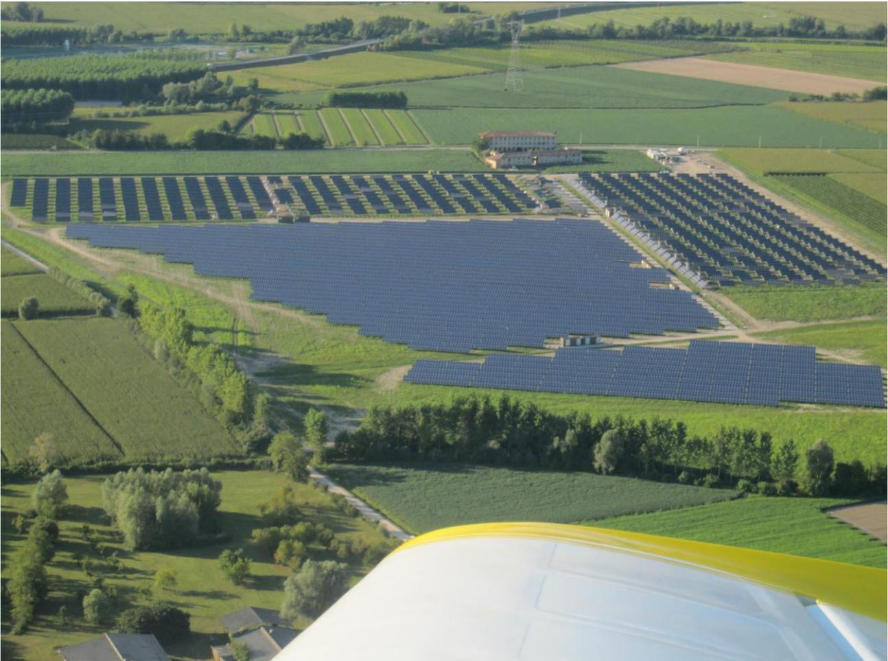
Das Foto zeigt die 2 Megawatt nachgeführten Systeme im Hintergrund und die 3 Megawatt fixe Aufständering im Vordergrund.
